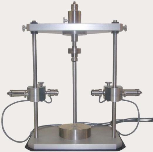
**概述:** GDS弯曲元试样中心夹持器是用于测量圆柱体土样中的S波和P波波速。试样夹持器有助于将垂直和水平弯曲元件精确安装在土样周围，并提供一个微小的耦合荷载，以保证土样和元件接触良好。试样夹持器也保证了元件的夹持是高度静态的，其产生的噪音与人工夹持元件的噪音相比更小。
