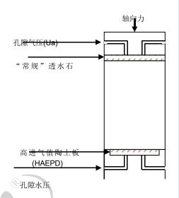
图 1 采用 GDS 方法 A 进行试验时的连接示意图
