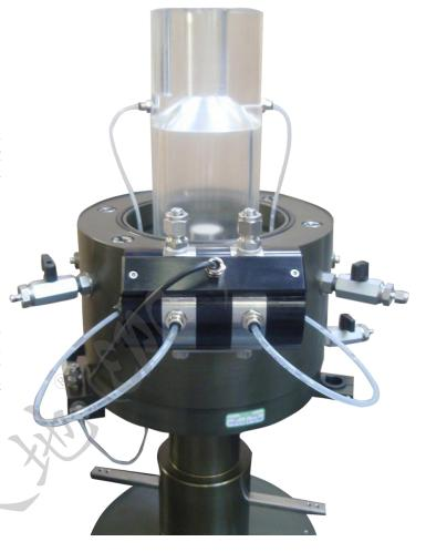
图 3 HKUST 内压力室和 DPT 连接示意图
